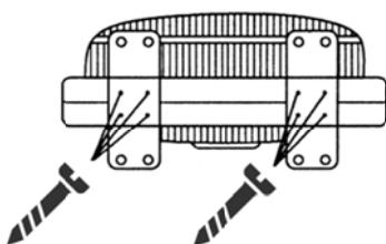
Installez les supports en utilisant les vis fournies
