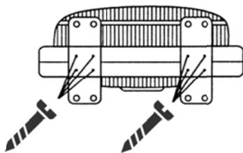
Instale os suportes usando os parafusos fornecidos
