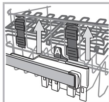
Si el cesto tiene **Lift-Up\*** (ver la figura), sujetarlo por los costados y levantarla. Para volver a la posición inferior, pulsar las palancas (A) a los costados del cesto y acompañarlo hacia abajo.
