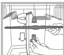
Üst püskürtücü kolunu çıkarmak için, plastik kilitleme halkasını saat yönünün aksine istikametinde döndürün. Üst püskürtücü kolu daha çok sayıda delik bulunan taraf yukarı bakacak şekilde değiştirilmelidir.
