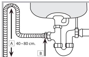
Перед подсоединением сливного шланга к сифону мойки снимите пластиковую пробку (B).
