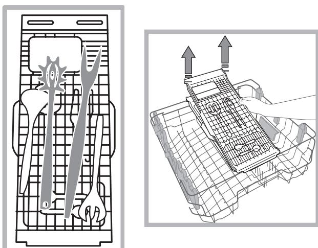
Перед загрузкой лотка проверьте, чтобы крепления былиочно прикреплены к верхней корзине. (см. схему)
