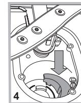
После чистки фильтров точно установите фильтрующий узел на свое место, что является важным для исправной работы посудомоечной машины.
