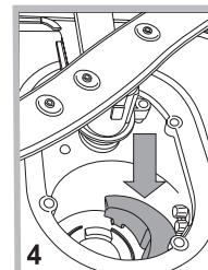
Filtreleri temizledikten sonra filtre grubunu yeniden yerine takın ve sabitleyin; bu durum bulaşık makinesinin verimli kullanımının elde edilmesi için gereklidir.
