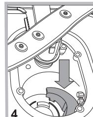
Después de la limpieza de los filtros, volver a montar el grupo filtrante y a colocarlo correctamente en su lugar. Esto es fundamental para el buen funcionamiento del lavavajillas.
