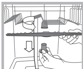
Para desmontar el rociador superior, es necesario desenroscar en sentido antihorario la virola de plástico. El rociador superior se vuelve a montar con la parte que tiene el mayor número de orificios dirigida hacia arriba.
