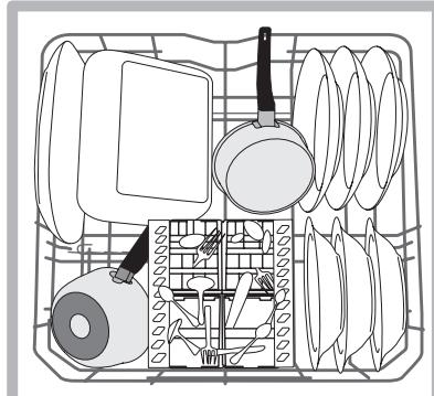
Рекомендуется разместить сильно грязную посуду в нижней корзине, так как в этой части струи воды более сильные и обеспечивают оптимальную мойку посуды.
