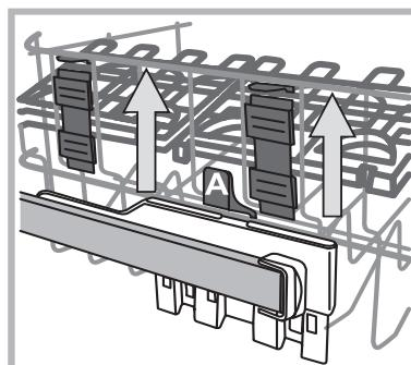
Если корзина оснащена Lift-Up\* (см. схему), поднимите корзину, взявшись за нее с боков и переместив ее вверх. Для опускания корзины вниз нажмите на рычажки (A) с боков корзины и направьте корзину вниз.
