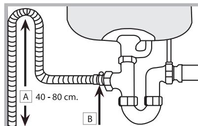
Antes de conectar el tubo de descarga del agua al sifón del lavabo, quitar el tapón de plástico (B).
