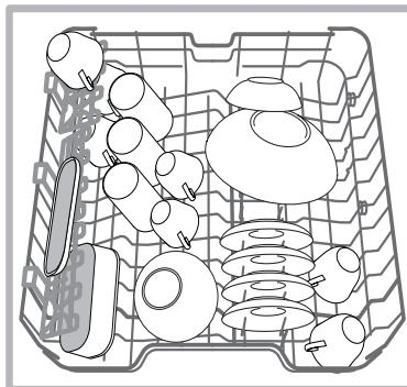
В некоторых моделях посудомоечных машин имеются откидные секции\*, используемые в вертикальном положении для размещения чайных блюдец или десертных тарелочек или в опущенном положении для размещения мисок и пищевых коробок.
