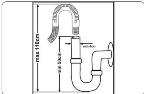
Conecte el tubo de desagüe de agua directamente en el agujero de desagüe o en la salida del fregadero. Esta conexión debe estar como mínimo a 50 cm y como máximo a 110 cm del plano del suelo.
