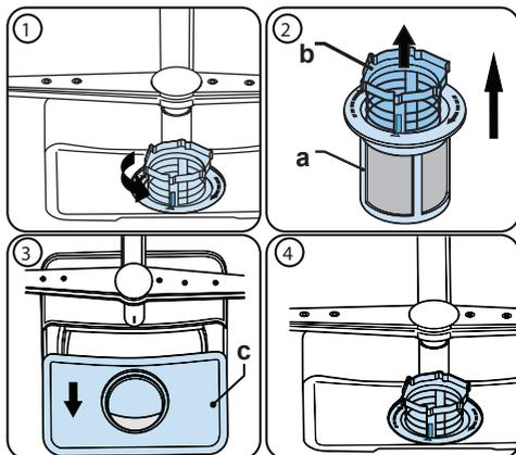
Para extraer y limpiar el conjunto de filtros, gírelo en sentido contrario a las agujas del reloj y extráigalo levantándolo hacia arriba (1). Saque el filtro grueso del filtro micro (2). Luego saque y retire el filtro metálico (3). Aclare el filtro con abundante agua hasta que quede libre de residuos. Vuelva a montar los filtros. Coloque de nuevo el conjunto de filtros y gírelo en el sentido de las agujas del reloj. (4).
