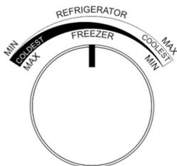
Cuando el modo de temperatura se mantiene sin cambios, ajuste la varilla reguladora de aire de izquierda a derecha, la temperatura del refrigerador disminuye mientras aumenta la temperatura del congelador.
