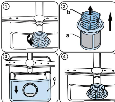
Para extraer y limpiar la combinación de filtros, gírela hacia la izquierda y extráigala levantándola hacia arriba (1). Extraiga el filtro grueso del microfiltro (2). A continuación, tire del filtro metálico y extráigalo (3). Aclare el filtro con abundante agua hasta que quede libre de residuos. Vuelva a montar los filtros. Vuelva a colocar el cartucho del filtro y gírela hacia la derecha (4).
