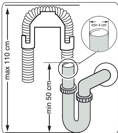
La manguera de desagüe puede conectarse directamente al orificio de desagüe o al conducto de salida del fregadero. Esta conexión debe estar a una distancia mínima de 50 cm y máxima de 110 cm del suelo donde se instale el lavavajillas.
