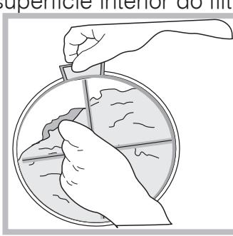
3. Substitua correctamente o filtro. Certifique-se de que o filtro está completamente colocado no interior da porta.
