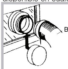
Dependiendo de la frecuencia con la que use la secadora, es esencial que las áreas A y B se comprueben periódicamente para retirar las pelusas o la suciedad. El adaptador del tubo de ventilación debe ajustarse de forma segura a fin de evitar que el aire húmedo se distribuya por la habitación.
