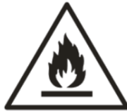
Atención, riesgo de incendio
